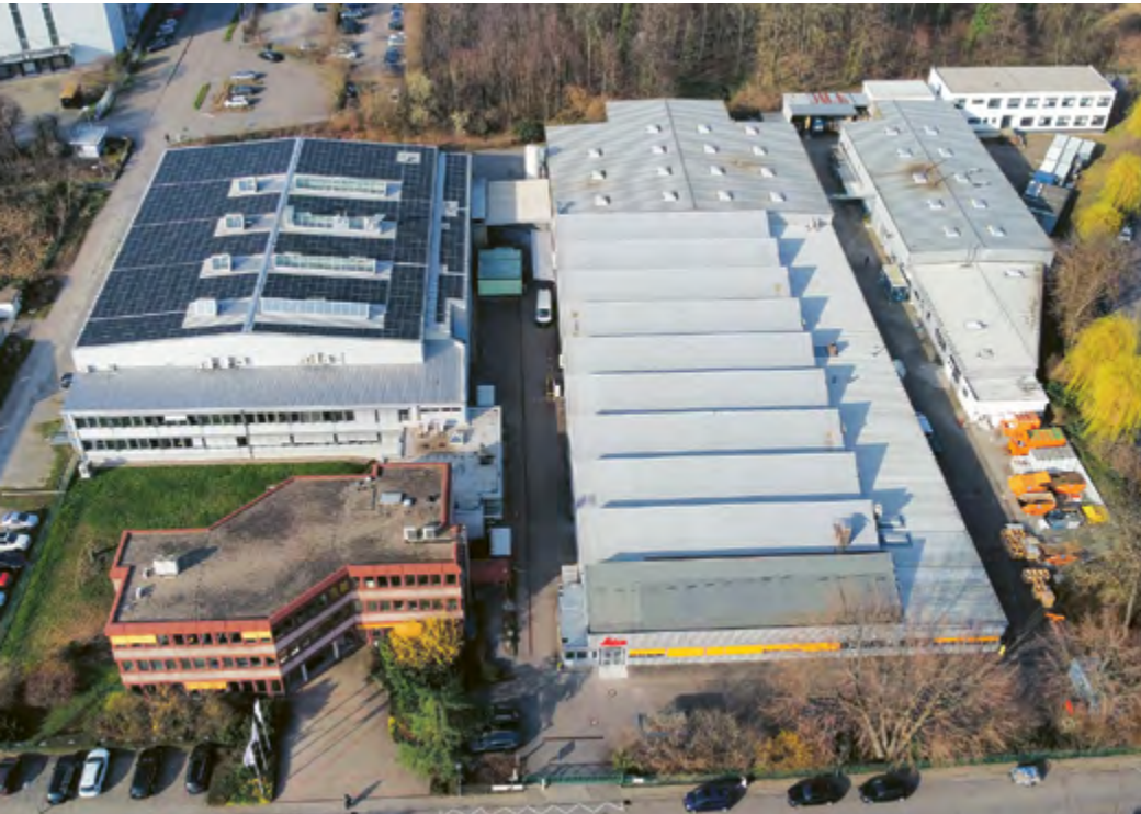
Photovoltaik auf dem Nußlocher Werksgelände: Leica Biosystems installierte dank der Unterstützung durch den KEFF+ Check eine 302 kWp PV-Anlage, spart jährlich 65.000 Euro Stromkosten und plant eine Erweiterung.
